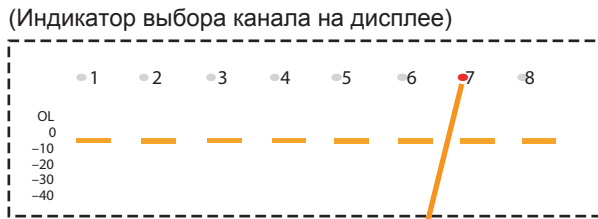
При выборе соответствующего канала, индикатор загорается красным.
